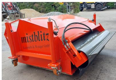
Mit seinen frei schwenkbaren und höhenverstellbaren Rädern bietet der KW 6 Vorteile auf festen Untergründen. Bewährt vor allem auf Kunststoff- und Gummiböden.
